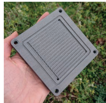
Foto einer Titan-Komposit- Bipolarplatte im Labormaßstab.
